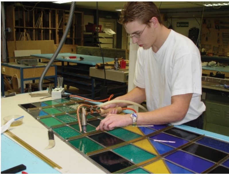
Puntafzuiging bij het solderen van glas in lood
