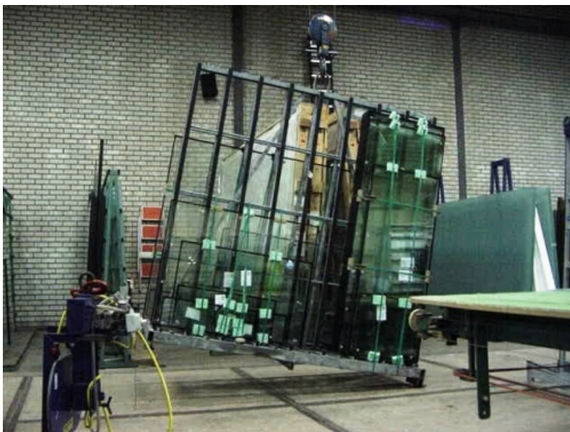
Verkeerd beladen glasbok, waardoor niet veilig kan worden gehesen
