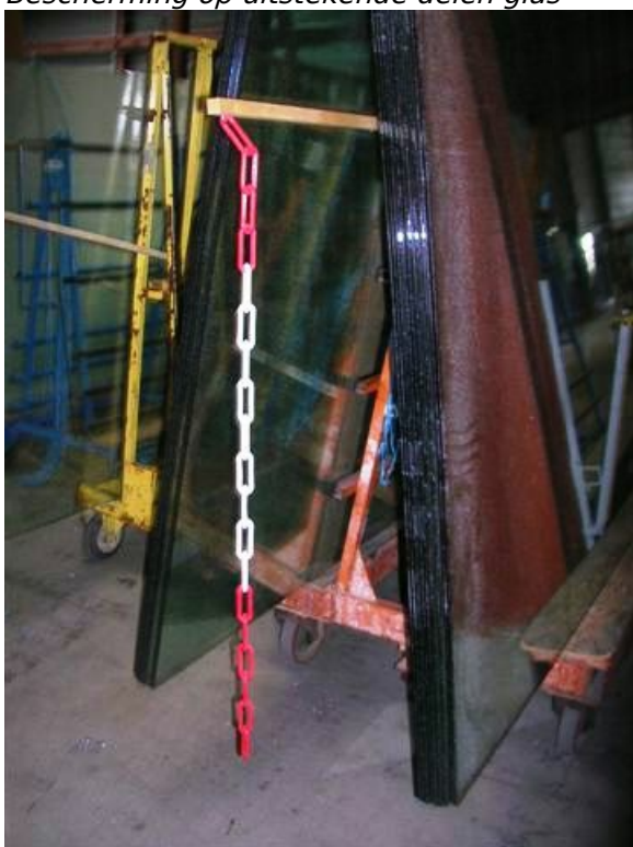
Markering met behulp van een ketting
