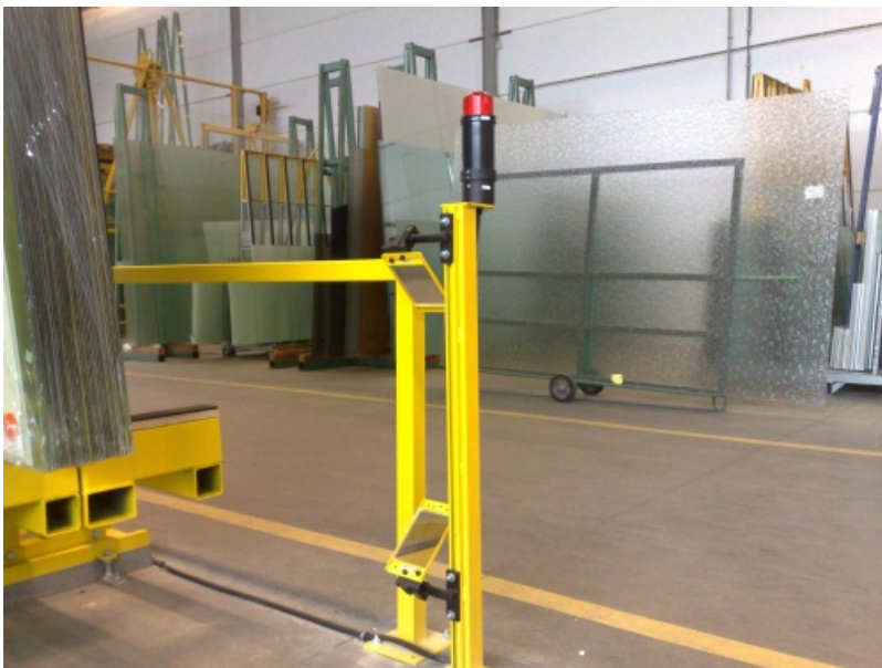
Beveiliging van automatisch schuifstellingen met behulp van sensoren
