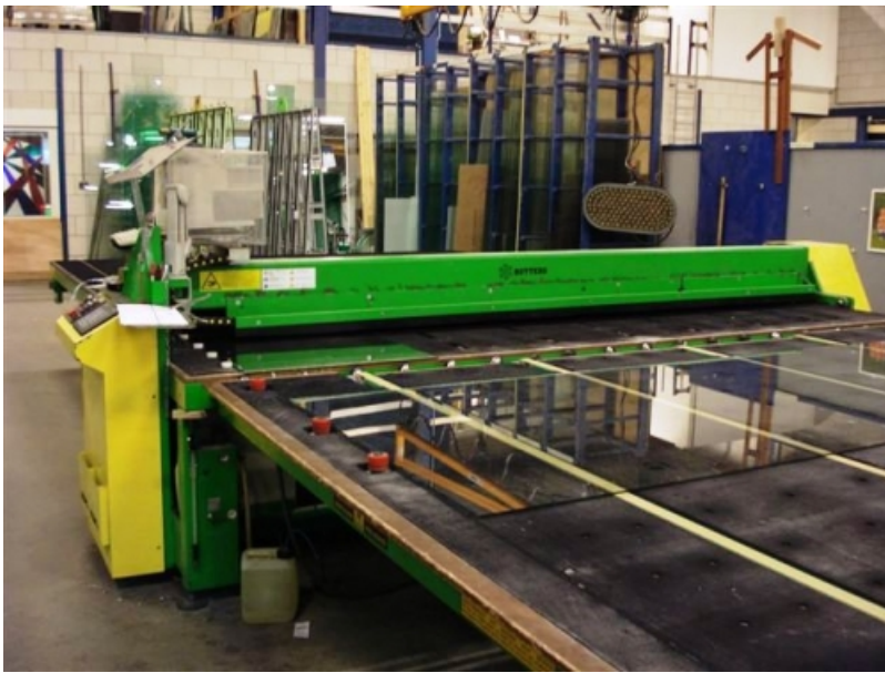
Snijtafel voor gelaagd glas zonder beveiliging
