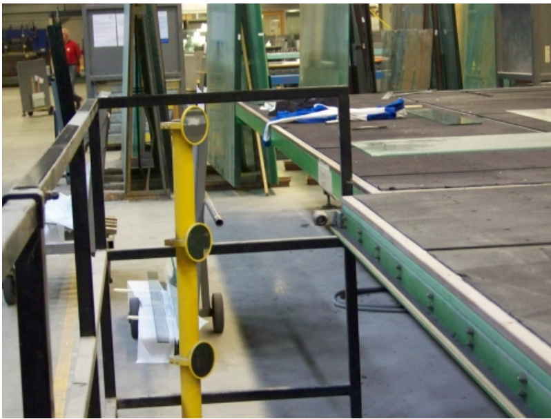
Beveiliging van een computergestuurde snijtafel met behulp van hekwerken en sensoren
