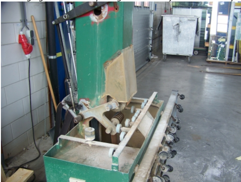
Beschermkap op een bandslijpmachine
