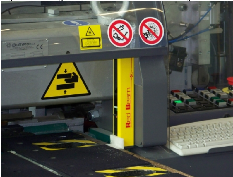
Snijtafel voor gelaagd glas met sensoren tegen beknelling
